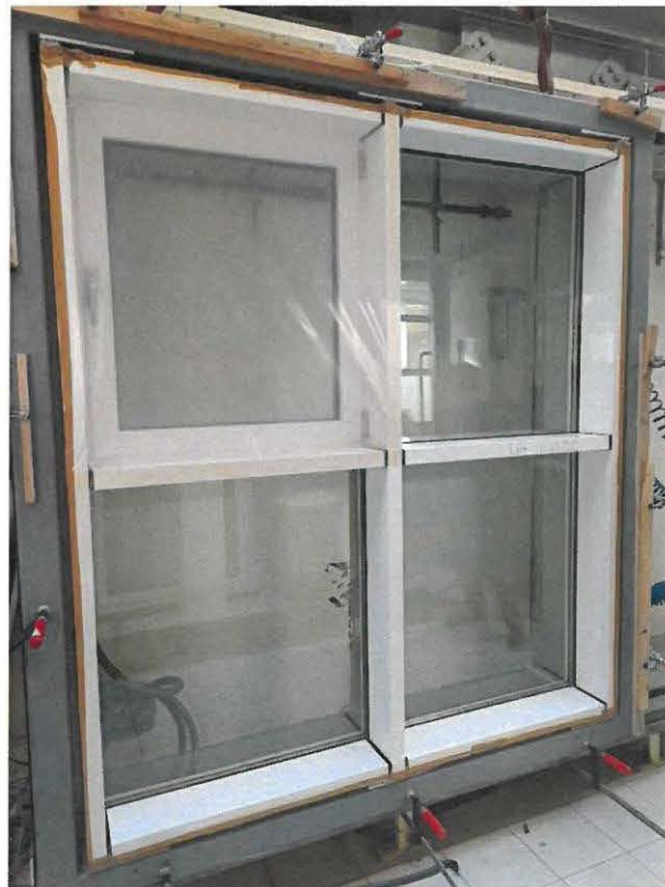
Slika 8: zrakonepropusnom membranom prekriven samo otvarajući dio elementa.
